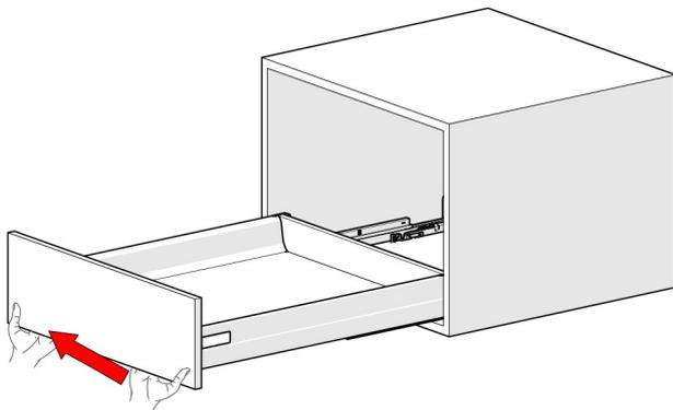
Bis zum Anschlag öffnen und leicht anheben
