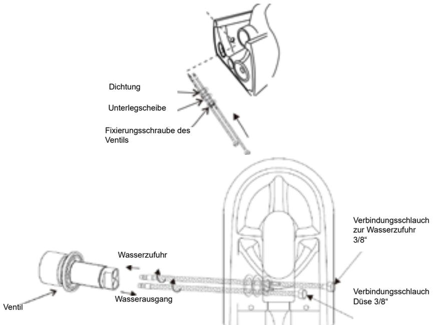
2. Stellen Sie nun mit Hilfe der Schläuche die Verbindung zwischen der hausinternen Wasserleitung und der Toilette und Düse her. Bedenken Sie, dass ein Rohrunterbrecher installiert werden muss.
