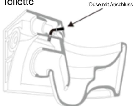
1. Führen Sie die Schläuche gemäß der Skizze in die vorgebohrten Löcher. Fixieren Sie das Ventil indem Sie die Kontermutter anziehen, die Armatur ist dann richtig verschraubt, wenn Sie sich nicht mehr bewegt, der Regler sich aber weiterhin drehen lässt.
