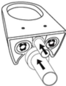
2. Fetten Sie die Enden der Rohre und auch die hausinternen Anschlüsse ein um das Einsetzen zu erleichtern
