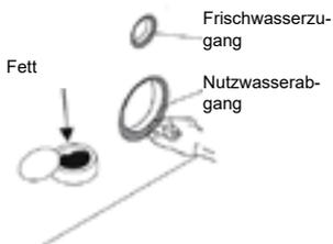
3. Setzen Sie die Toilette sorgfältig an den Frischzu- bzw. Nutzwasserabgang. Achten Sie darauf, dass die Installationsmutter und der Installationsbolzen mit seiner Vertiefung sauber übereinanderliegen. Drücken Sie die Toilette vorsichtig bis zum Fliesenspiegel.
