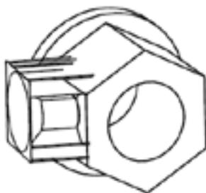
4. Setzen Sie nun die Installationsmutter in die dafür vorgesehenen Löcher der Toilette ein und drehen Sie Führung in die Mutter.
