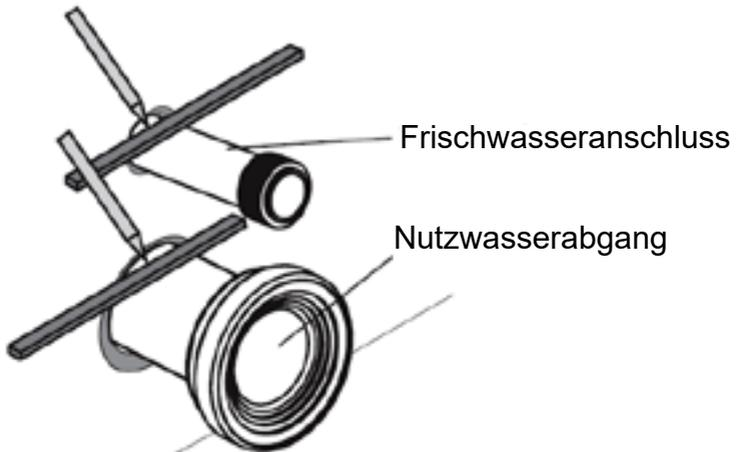
2. Drücken Sie die Rohre bis zum Anschlag auf die Anschlüsse der Toilette, markieren Sie mit einem Stift die Schnittstelle von Rohr und Toilette.
