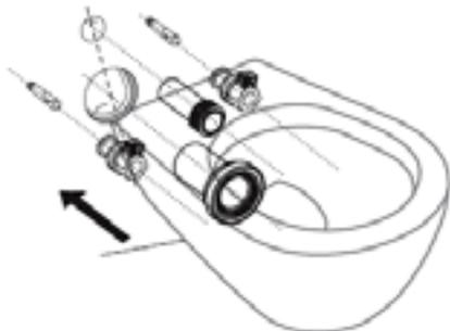
4. Ziehen Sie die Madenschraube mit Hilfe des Inbus vollständig an.
