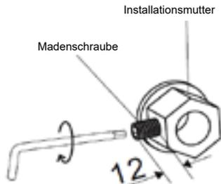
2. Setzen Sie die Führung auf die Installationsmutter auf.
