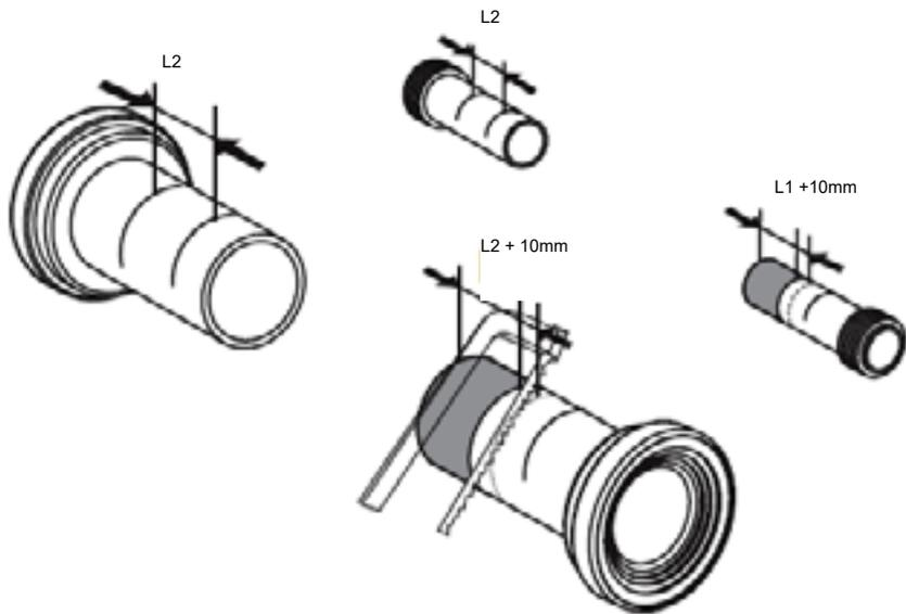
4. Schleifen Sie die Enden der Rohe in einem  $45^\circ$  Winkel an.
