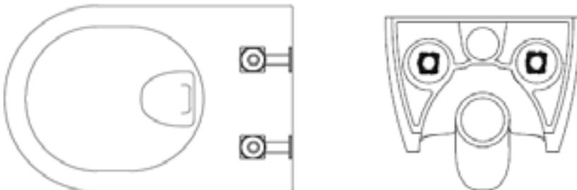
6. Die Stockschrauben des Vorwandinstallationselements werden bis auf 35mm in das Element geschraubt, der Verbindungsbolzen wird auf die Stockschrauben aufgeschraubt, es wird hierbei eine Abstand von 10mm zwischen Wand und Verbindungsbolzen eingehalten.
