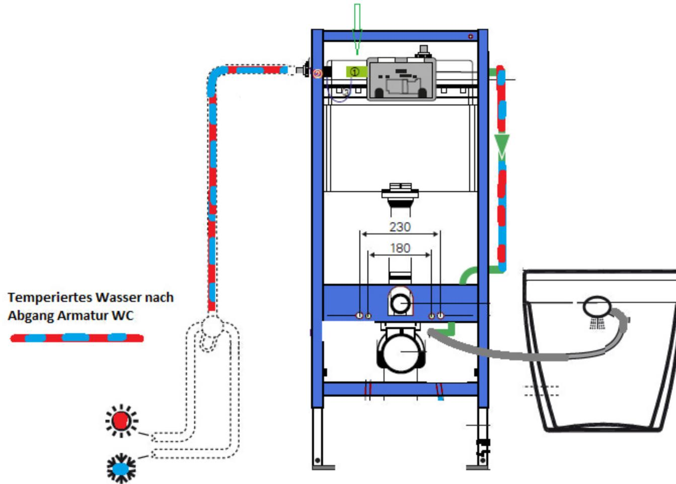
Die Armatur (UP-Ventil, UP-Brausearmatur, etc.) ist so zu installieren, dass sie im Sitzen vom WC aus komfortabel bedient werden kann.
